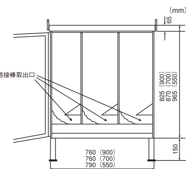
・溶接棒を取り出す際は、溶接棒が熱くなっていますのでわざ手袋等装着の上取り出してください。
